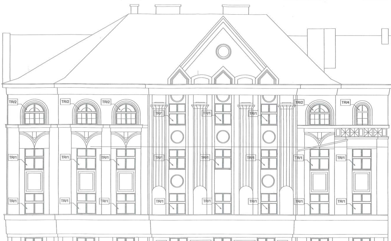
Uliční průčelí do Dominikánské ulice, 3. – 5. NP okna (TR/1a TR/2) a balkónové dveře (TR/4)
