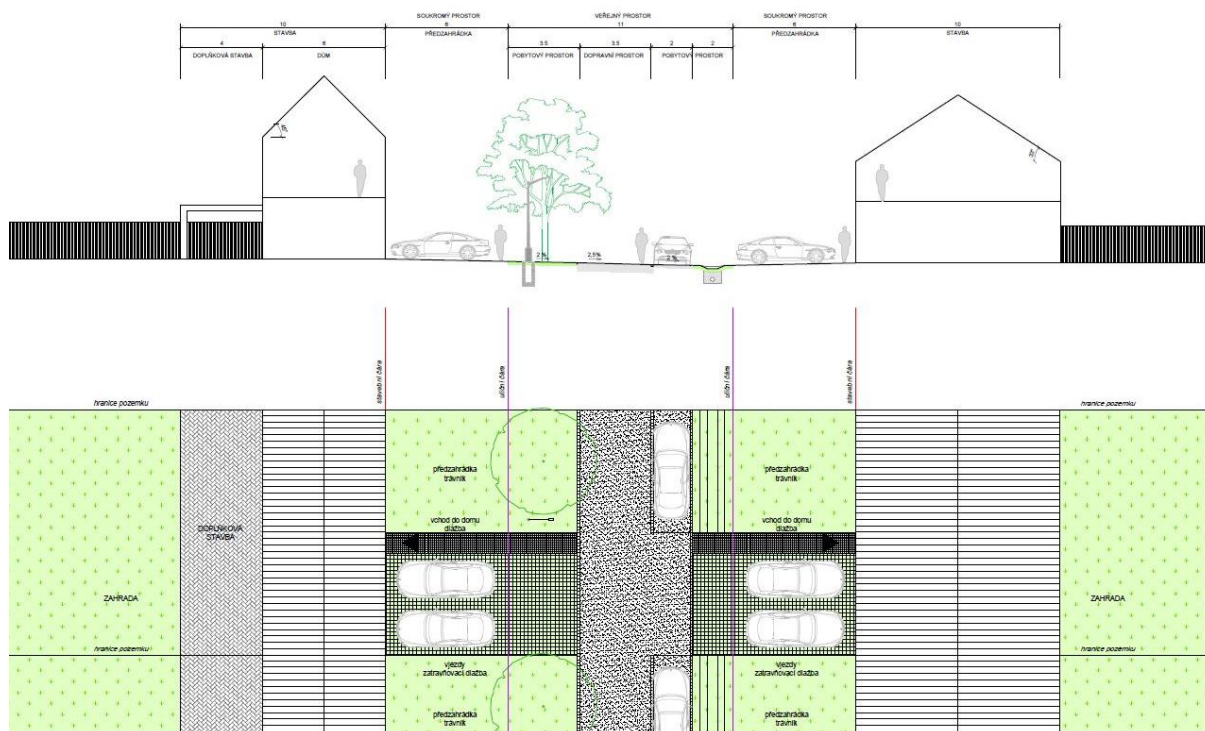
Obrázek č. 7: výřez z výkresu č. C.6 – příklad hloubky domů a různého sklonu sedlové střechy
